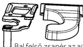
Bal felső zsanér az ajtó megfordíthatóságához
