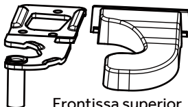
Frontissa superior esquerra per a la reversibilitat de la porta Tapa de la frontissa superior esquerra
