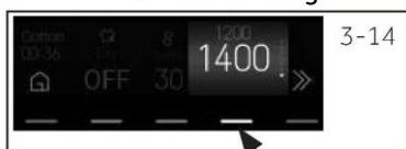
1. Toccare "Centrifuga" per selezionare una velocità diversa (0/400/600/800/1000/1200/1400). (Fig.3-14).
