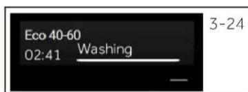
1. Scegliendo un programma e avviandolo, toccare "—" (Fig.3-24) per 3 secondi: la funzione Blocco bambini si abilita e sullo schermo viene visualizzato "Blocco bambini attivo"(Fig.3-25).
