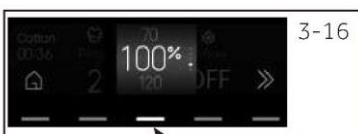
Toccare "Detersivo" per selezionare il dosaggio del detersivo (OFF/40%/70%/100%/120%) (Fig. 3-16).
