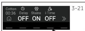
Toccare "i-Time" (Fig.3-21) per selezionare il tempo di lavaggio (Fig.3-22) e il sistema regolerà automaticamente le impostazioni ottimali dei parametri.
