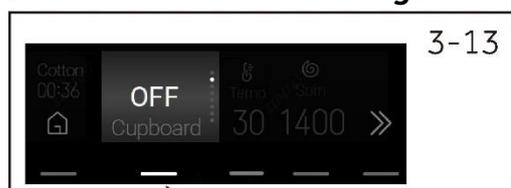
1. Effleurez « Séchage » pour régler le niveau de séchage (Arrêt/Prêt à ranger/Extra sec/Repassage facile) ou la durée de séchage (00:30/01:00/01:30/02:00) (Fig. 3-13).
