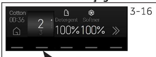
1. Effleurez « Rinçage » pour sélectionner le nombre de rinçages (0/1/2/3/4/5). (Fig. 3-16).
