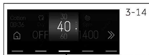
1. Effleurez « Temp. » pour sélectionner une température différente (--/20/30/40/60/90). (Fig. 3-14).
