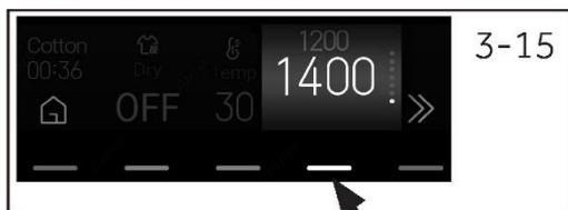
1. Effleurez « Vitesse » pour sélectionner une vitesse différente (0/400/600/800/1000/1200/1400). (Fig. 3-15).
