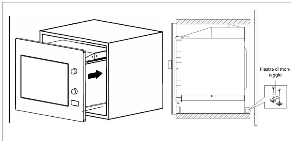
5. Aprire la porta, fissare il forno al mobile con la vite B, al foro di installazione.
