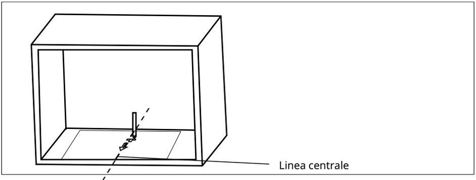
3. Rimuovere il template del mobile inferiore e fissare la piastra di montaggio con la vite A.
