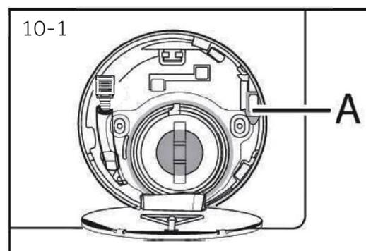
**i** Lorsque le lave-linge est sûr (niveau d'eau sous le hublot sur une certaine distance, température du tambour inférieure à 55 °C, absence de rotation du tambour intérieur), il est possible de déverrouiller les portes du lave-linge.
