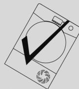
Wenn das Gerät in eine andere Lage transportiert wurde, warten Sie mindestens 4 Stunden, bevor Sie es einschalten, damit sich die Flüssigkeit im Kompressor wieder stabilisieren kann. Tun Sie es nicht, können Schäden am Kompressor die Folge sein.
