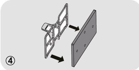
5. Den Schwamm reinigen und hierzu Staub und Flusen entfernen. Es ist möglich, hierzu einen Staubsauger zu verwenden. Den Schwamm vorsichtig wieder auf den Rahmen setzen.
