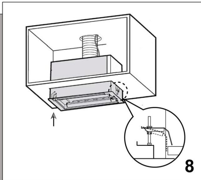
Insérez la hotte aspirante de bas en haut dans l'armoire jusqu'à ce que le support de verrouillage repose sur l'étagère inférieure.
