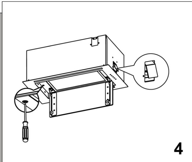
Преди монтажа отворете преградата за мазнини и завъртете болта по посока на часовниковата стрелка с отвертка, за да го разхлабите за лесен монтаж. Разхлабете монтажната конструкция, плътно прикрепена към корпуса, с отвертка, за да улесните монтажа на цялата машина.
