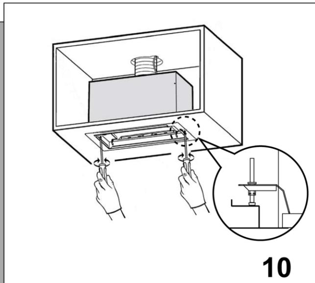
Open het vetfilter en verwijder de twee bevestigingsschroeven met een schroevendraaier. Til het omhoog tot het volledig in de bodem van de kast is geïnstalleerd. Draai de schroeven van de afzuigkap vast.
