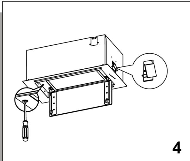
Antes de la instalación, abra el deflector de aceite y gire el perno en el sentido de las agujas del reloj con un destornillador para aflojarlo y facilitar la instalación. Afloje con un destornillador la estructura de montaje fijada a la carcasa para facilitar la instalación de toda la máquina.
