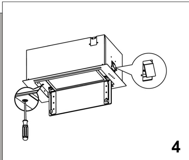
Avant l'installation, ouvrez le déflecteur d'huile et tournez le boulon dans le sens des aiguilles d'une montre à l'aide d'un tournevis pour le desserrer afin de faciliter l'installation. Pour faciliter l'installation de l'ensemble de la machine, desserrez la structure de montage fixée sur le boîtier à l'aide d'un tournevis.
