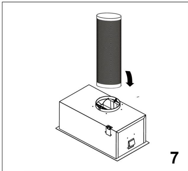
Kinnitage väljalasketoru toruadapteri külge ja asetage see väljatõmbekapi peale, nagu joonisel näidatud.
