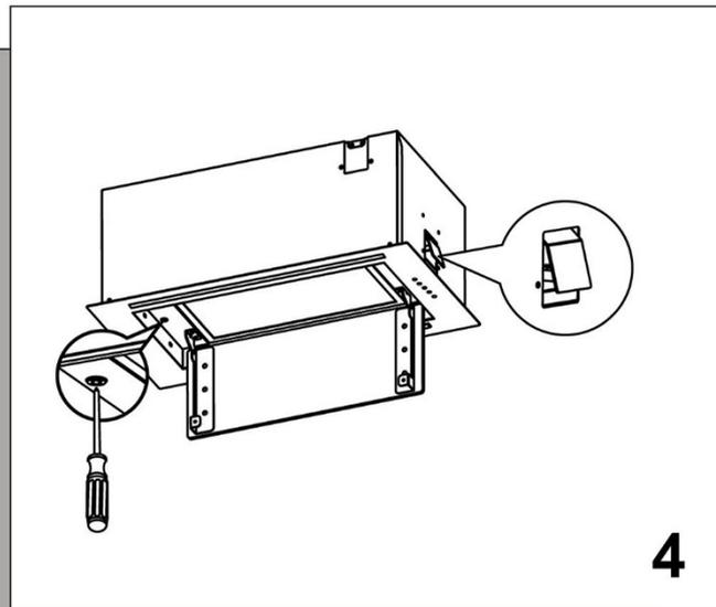
Beszereles előtt nyissa ki az olajterelőt, és csavarhúzóval forgassa el a csavart az óramutató járásával megegyező irányba a meglazításhoz, így megkönnyíti a beszerelést. Lazítsa meg a házhoz szorosan rögzített rögzítőszerkezetet egy csavarhúzóval, így megkönnyíti a teljes készülék beszerelését
