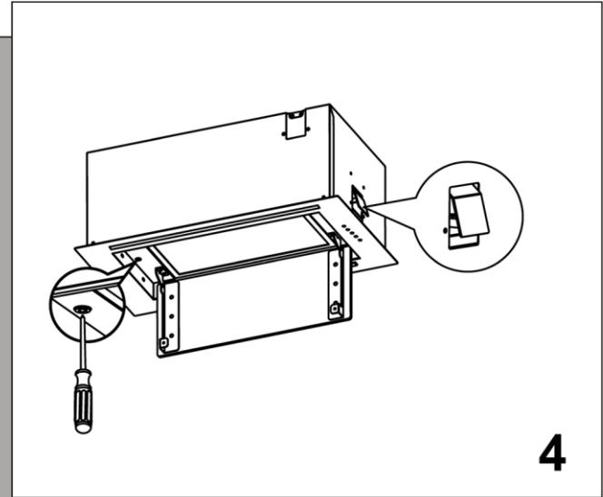
Öffnen Sie vor der Installation das Ölabweisblech und drehen Sie die Schraube mit einem Schraubendreher im Uhrzeigersinn, um sie zu lösen und den Einbau zu erleichtern. Lösen Sie die fest mit dem Gehäuse verbundene Befestigungsstruktur mit einem Schraubendreher, um die Installation der gesamten Maschine zu erleichtern.
