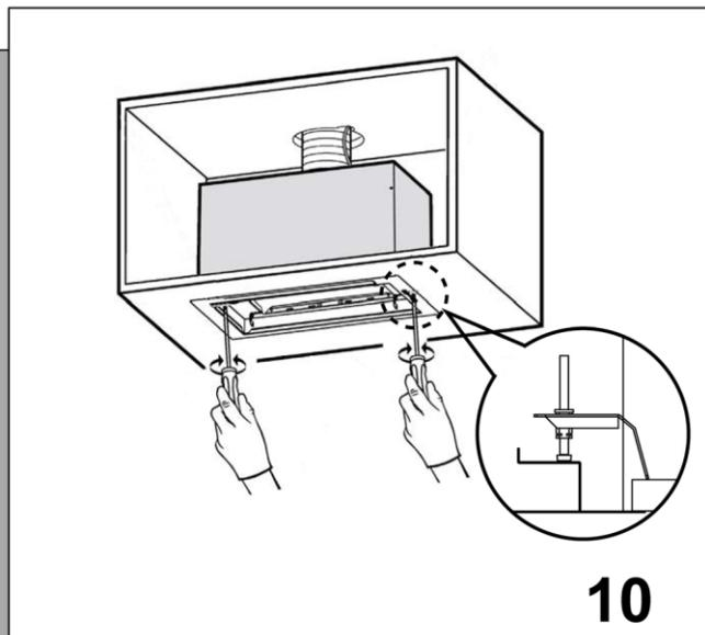
Abra el filtro de grasa y retire los dos tornillos de fijación con un destornillador. Levántelo hasta que quede completamente instalado en la parte inferior del armario. Apriete los tornillos de fijación de la campana extractora.
