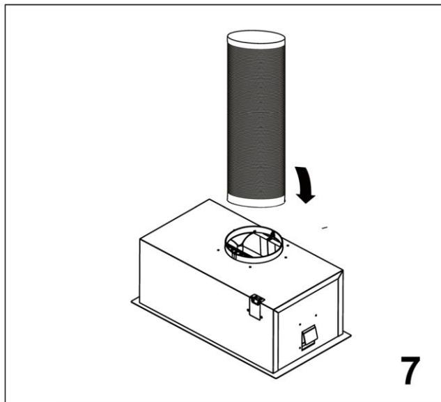
Pripojte odvodné potrubie k adaptéru potrubia a umiestnite ho nad odsávač pár podľa obrázka.
