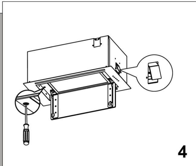
Przed montażem należy otworzyć przegrodę oleju i obrócić śrubę zgodnie z ruchem wskazówek zegara za pomocą śrubokręta, aby ją poluzować w celu ułatwienia montażu. Poluzuj konstrukcję montażową ściśle przylegającą do obudowy za pomocą śrubokręta, aby ułatwić montaż całego urządzenia.
