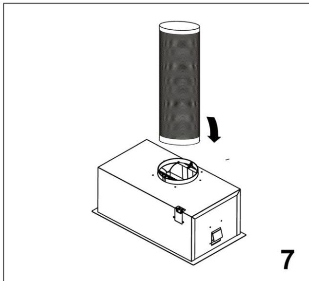
Fije el tubo de extracción al adaptador de tubo y colóquelo sobre la campana extractora tal como se muestra.
