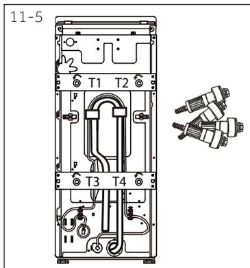
1. Entfernen Sie alle 4 Schrauben (T1 - T4) (Abb. 11-5).
