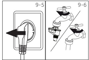
Überprüfen Sie vor dem nächsten Einsatz Netzkabel, Wasserzulauf und Ablaufschlauch sorgfältig auf Beschädigungen bzw. festen Sitz. Vergewissern Sie sich, dass alles richtig installiert ist, kein Wasser ausläuft.
