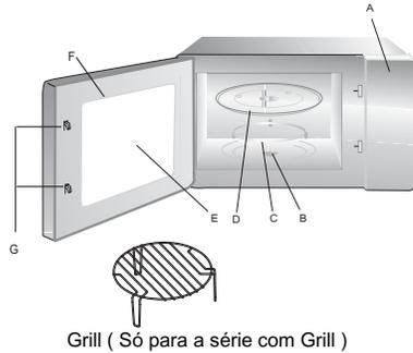
Atenção! Não utilize a grelha de metal quando utilizar o aparelho com microondas. Remova-a sempre que utilizar a função microondas!
