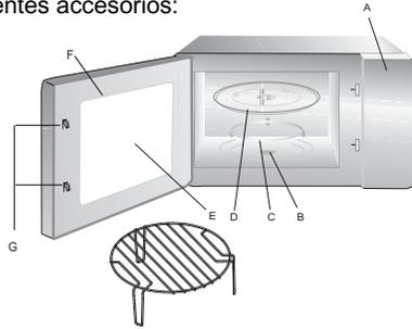
Atención: no utilice la rejilla metálica en el modelo de microondas. ¡Quítela siempre cuando utilice la función de microondas!
