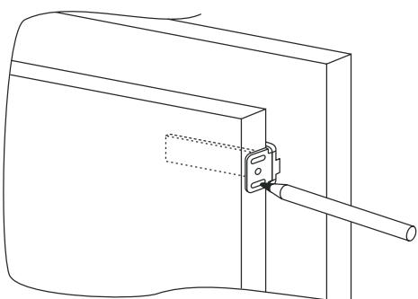
Verbind de apparaatdeur met het kastpaneel en gebruik de ladersleuven als richtlijn.
