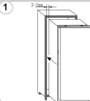
Po zapewnieniu pasowania między drzwiami urządzenia a drzwiami zabudowy meblowej, przykręcić górną część urządzenia do szafki.
