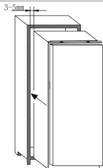
Após se assegurar da correspondência entre a porta do aparelho e a porta da coluna, aparafuse a parte superior do aparelho ao armário.
