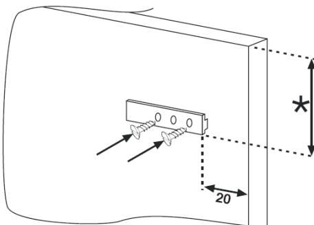
Deschideți ușile coloanei încorporate și ale frigiderului. Poziționați încărcătorul încorporat în glisieră, apoi montați-l în ușă frigiderului.
