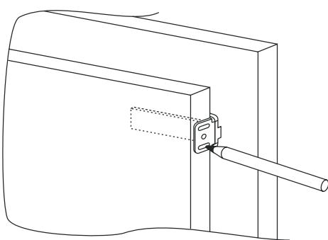
Die Gerätetür mit der Korpusfront verbinden und die Schlitzes des Mitnehmers zur Ausrichtung verwenden.
