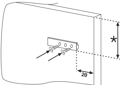
Otworzyć drzwi szafki i lodówki. Włożyć wbudowaną wkładkę do ślimacza, a następnie przyłożyć do drzwi lodówki.
