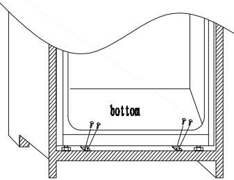
Die Dichtung des Geräts anbringen und bei Bedarf überstehende Teile abschneiden. Die Bodenelemente mit den Kunststoffabdeckungen befestigen.
