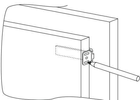
Conecte la puerta del aparato al panel del armario utilizando las ranuras del cargador a modo de guía.
