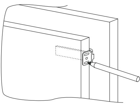
Collegare lo sportello dell'elettrodomestico al pannello del vano utilizzando le scanalature della slitta come guida.
