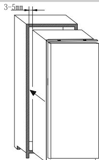
Die korrekte Ausrichtung der Gerätetür zur Korpusfront prüfen und die Oberseite des Geräts am Korpus festschrauben.
