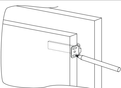
Připevněte dveře spotřebiče k panelu skříně a použijte při tom zavaděče pro určení polohy.
