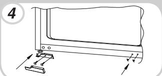
Die Türen und Scharniere von unten nach oben (s. 1-2 in der Abb.) montieren.
