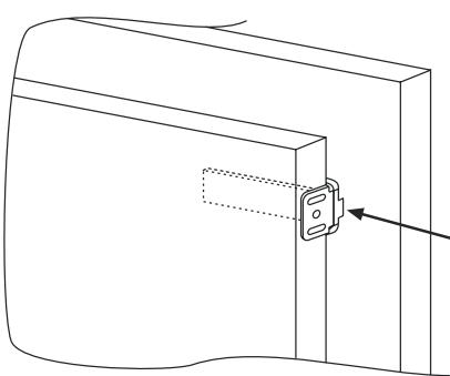
Marquer les points de fixation des vis et percer avec un foret de 2,5 mm de diamètre.
