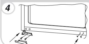
Vuelva a montar las puertas y las bisagras de abajo hacia arriba, (puntos 1-2).
