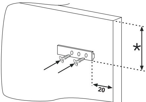
Abra as portas da coluna embutida e do frigorífico. Posicione o carregador embutido na corrediça e encaixe na porta do frigorífico.
