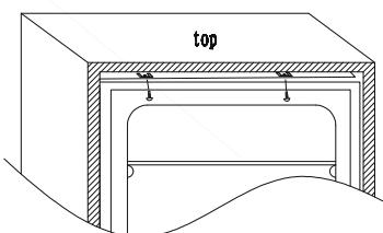
Schroef het onderste deel van het apparaat aan de kast vast.
