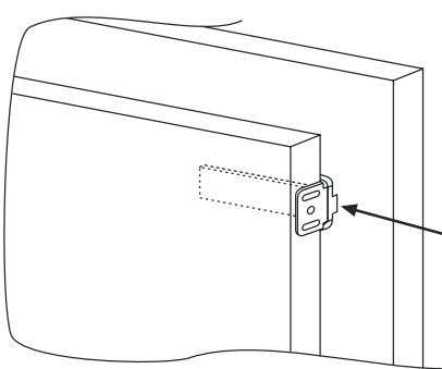
Σημειώστε τα σημεία στερέωσης για τις βίδες και ανοίξτε τρύπες με τρυπάνι διαμέτρου 2,5 mm.
