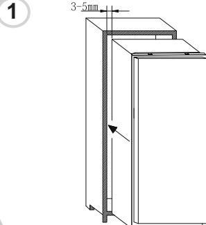
Accertarsi che lo sportello dell'elettrodomestico sia allineato all'anta dell'incasso e avvitare la parte superiore dell'elettrodomestico al vano
