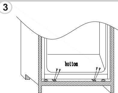
Applicare la guarnizione all'elettrodomestico e tagliare l'eventuale parte in eccesso. Applicare le coperture di plastica alle parti inferiori.
