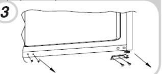
Utilizați balamaua și capacul de rezervă din sacul de accesorii și potriviti-le în partea inferioară stângă.
