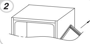
Remova a dobradiça do fundo à direita e os tampões de plástico da esquerda e volte a instalá-los no lado oposto.
