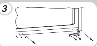
Das Scharnier für die linke Seite und die entsprechende Abdeckung unten links anbringen.
