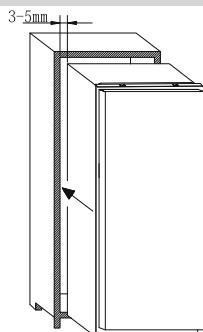
Nadat u ervoor gezorgd hebt dat er een overeenkomst is tussen de deur van het apparaat en de deur van de kolomkast, schroeft u het bovenste deel van het apparaat aan de kast vast.
