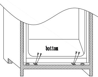
Umístěte těsnění spotřebiče, v případě potřeby uřízněte přečnívající část. Na spodní část nasaděte plastové kryty.
