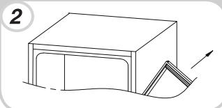
Zdemontować zawias prawy dolny i plastikowe zaślepki z lewej strony, a następnie zamontować je po stronie przeciwnej.
