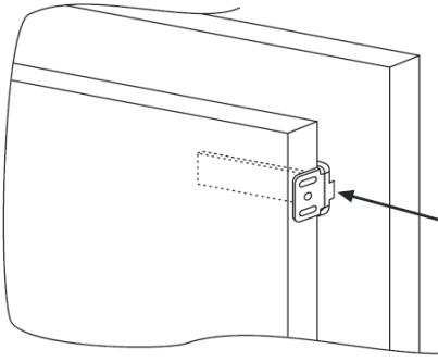
Маркирайте точките за закрепване с винтове и пробийте със свредло с диаметър 2,5 mm.
