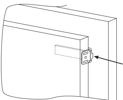
Marque os pontos de fixação para os parafusos e perfure com uma broca de 2.5mm de diâmetro.
