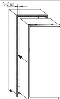
Zkontrolujte zarovnání dveří spotřebiče a skříně a poté přišroubujte horní část spotřebiče ke skříně.
