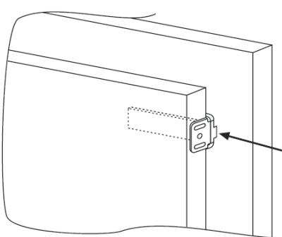
Marcați punctele de fixare pentru șuruburi și găuriți cu un burghiu cu un diametru de 2,5 mm.
