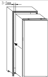
Après avoir vérifié que la porte de l'appareil et celle de la colonne coïncident, visser la partie supérieure de l'appareil sur le cabinet.
