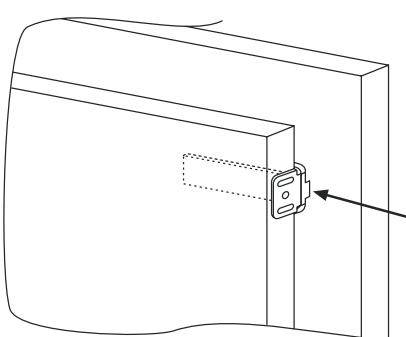
Označte body pro šrouby a vyroutejte otvory vrtákem o průměru 2,5 mm.
