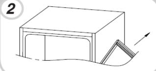
Îndepărtați balamaua inferioară din dreapta și dopurile de plastic din stânga, și montați-le din nou pe partea opusă.
