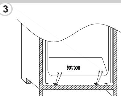
Założyć uszczelkę na urządzenie, w razie potrzeby odcinając nadmiar. Zamontować w dolnej części plastikowe pokrywy.
