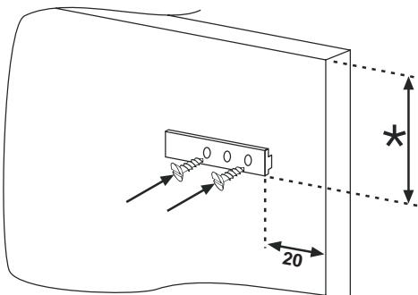
Ouvrir les portes de la colonne encastrée et du réfrigérateur. Positionner le support encastré dans la glissière, et ensuite l'introduire dans la porte du réfrigérateur.
