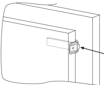
Marque los puntos de fijación para los tornillos y perfore unos orificios con una broca de 2,5 mm de diámetro.
