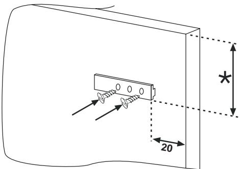
Abra las puertas de la columna encastrada y del frigorífico. Coloque el cargador integrado en la corredora e insértele en la puerta del frigorífico.
