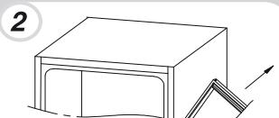
Retire la bisagra inferior derecha y los tapones plásticos de la izquierda y vuelva a colocarlos en el lado opuesto.
