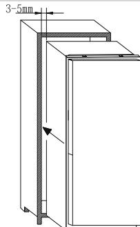
Después de comprobar la coincidencia entre la puerta del aparato y de la columna, atornille la parte superior del aparato al armario.
