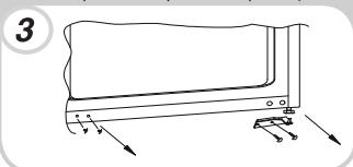
Χρησιμοποιήστε τον αντίθετο μεντεσέ και κάλυμμα και προσαρμόστε τα στην κάτω αριστερά γωνία.
