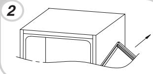
Retirer la charnière inférieure droite et les bouchons plastiques de gauche et les remettre en place sur le côté opposé.
