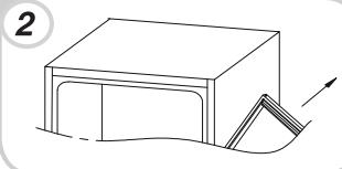
Αφαιρέστε τον κάτω δεξιά μεντεσέ και τα αριστερά πλαστικά βύσματα, και τοποθετήστε τα στην αντίθετη πλευρά.
