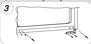
Gebruik de tegenovergestelde scharnier en afdekking en plaats linksonder.
