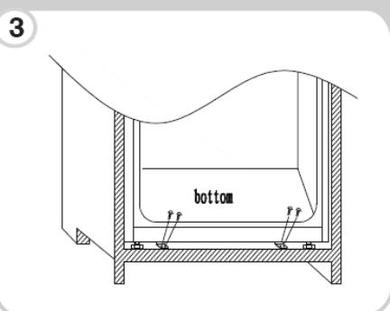
Montați garnitura pe aparat, tăiați partea excesivă dacă este necesar. Montați părțile inferioare cu capace de plastic.
