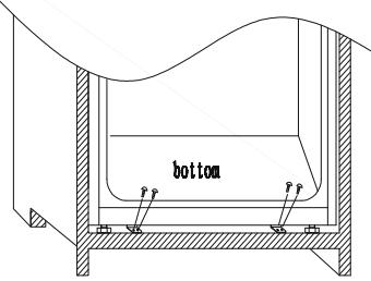
Ajuste o selo ao aparelho, corte o excedente se for necessário. Ajuste as partes inferiores com coberturas de plástico.
