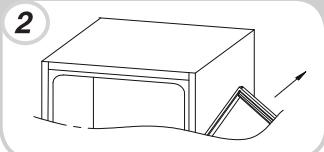
Das untere Scharnier rechts und die Kunststoffkappen links abnehmen und diese an der anderen Seite anbringen.
