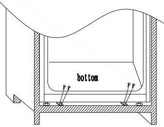
Coloque la junta del aparato y recorte el sobrante, en caso necesario. Coloque las tapas plásticas en la parte inferior.
