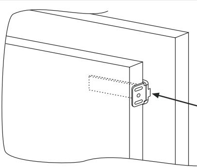
Contrassegnare i punti di fissaggio per le viti e praticare i fori utilizzando un trapano con una punta di 2,5 mm di diametro.
