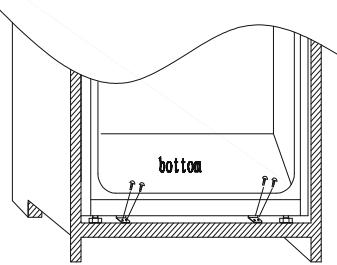
Plaats de afsluiting op de kast, snijd het overschot indien nodig eraf. Plaats de onderste delen met de plastic afdekkingen.
