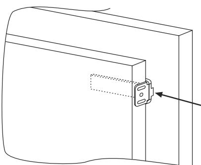
Markeer de bevestigingspunten voor de schroeven en boor met een bit van 2,5 mm diameter.
