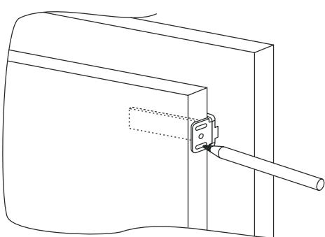
Raccorder la porte de l'appareil avec le panneau du cabinet en se servant des rainures du support comme lignes directrices.
