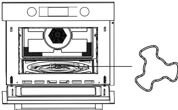
2. Ajuste o ângulo do tabuleiro; o dispositivo de rotação do tabuleiro deve ficar a apontar para um dos braços do veio.
