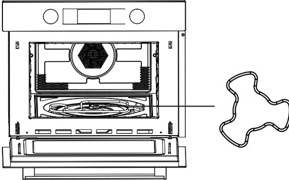
2. Justieren Sie die Position der Backpfanne; die Arme der Antriebswelle sollten auf gleicher Höhe mit den Rollen der Drehscheibe sein.
