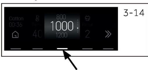
1. Toccare il pulsante "Velocità" (Fig.3-14) per selezionare una velocità diversa (0/400/600/800/1000/1200/1400).
