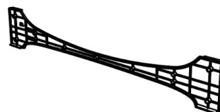
Dima di taglio per l'elemento di fissaggio del battiscopa (1) (Per consentire il taglio di un pannello battiscopa su misura da adattare al profilo del prodotto, a seconda della profondità del battiscopa)
