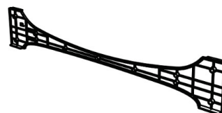
Gabarit de découpage de la pièce de fixation de la plinthe (1) (Pour permettre le découpage d'un panneau de plinthe sur mesure adapté au profil du produit, en fonction de la profondeur de la plinthe)
