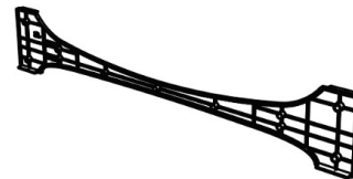
Schablone (1) zum Zuschneiden der Sockelleisten-Befestigung (Zuschneiden einer maßgefertigten Sockelleiste und Anpassen des Geräteprofils an die Tiefe der Sockelleiste)
