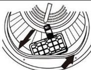
5. Reinigen Sie den Kondensatorfilter nach jedem Trockendurchgang (Abb. 9-14).
