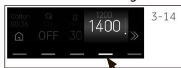
1. Effleurez la touche « Essorage » pour sélectionner une vitesse différente (0/ 400/ 600/ 800/ 1000/ 1200/ 1400/ 1600) (Fig. 3-14).
