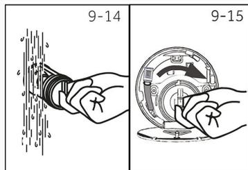
9. Nettoyez soigneusement le filtre de la pompe, par exemple, à l'eau courante (Fig. 9-14).
