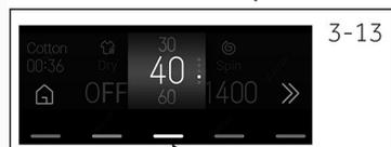
1. Effleurez la touche « Temp. » pour sélectionner une température différente (--/20/30/40/60/90) (Fig. 3-13).
