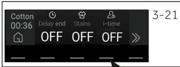
Berühren Sie „i-time“ (Abb. 3-21), um die Waschzeit auszuwählen (Abb. 3-22). Das System passt die optimalen Parametereinstellungen automatisch an.
