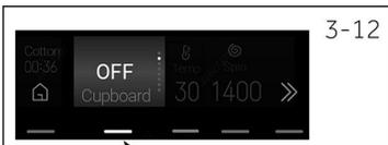
1. Tippen Sie auf „Trocknen“, um den Grad der Trocknung (AUS/ Schranktrocken/ Extratrocken/ Bügeltrocken etc.) oder die Trockenzeit (00:30/01:00/ 01:30 etc.) einzustellen (Abb. 3-12).
