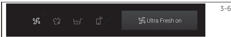
Wenn Sie diese Taste erneut berühren, erlischt das Frischluft-Symbol aus und auf dem Display wird „Ultra Fresh aus“ (Abb. 3-7) angezeigt.
