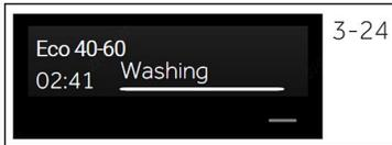
1. Wählen Sie ein Programm aus und drücken Sie Start. Drücken Sie „—“ (Abb. 3-24) 3 Sekunden lang. Die Kindersicherungsfunktion ist aktiviert und auf dem Bildschirm wird „Kindersicherung an“ (Abb. 3-25) angezeigt.
