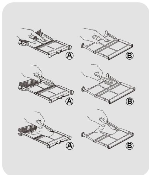
4. Fermez les deux filtres en les repositionnant à l'intérieur de la porte, en vous assurant qu'ils sont correctement positionnés.
