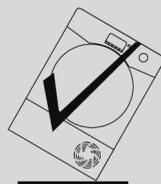
Si le produit est transporté différemment, attendez au moins 4 heures avant d'allumer l'appareil, ceci afin que le gaz liquide retourne dans le compresseur. En cas de non respect de cette procédure, le compresseur pourrait être endommagé.
