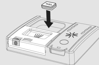
Nakon što deterdžent ulijete u spremnik, ponovno zatvorite vrata, gurajući u smjeru strelice dok ne kliknu na mjesto.
