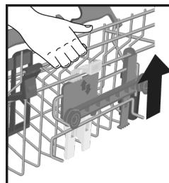
Če jo želite spustiti: košarico primite ob straneh, pritisnite dve ročici B ob straneh košarice in jo spustite.
