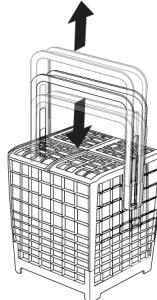
Primer pozicioniranja pregrade za escajg prikazan je na **slici 9**.
