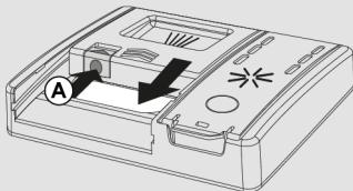
Po vlivanju detergenta v posodo zaprite vratca s pritiskom v smeri puščice, da se s klikom zaskočijo na ustreznom mestu.
