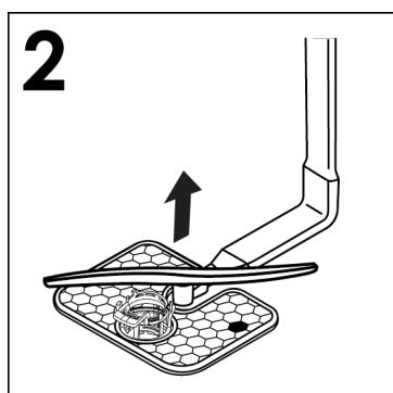
3) roke rotorja operite pod curkom vode, da odstranite morebitno zamašitev v razpršilnih glavah (sl.3);
