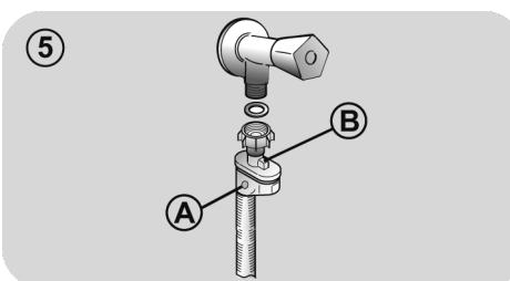
● **AQUAPROTECT - PŘÍVODNÍ HADICE S OCHRANOU (obr. 6):** Pokud voda přeteče z hlavní interní hadice "A", transparentní izolační plášť "B" udrží vodu k dokončení pracího cyklu. Na konci cyklu kontaktujte autorizované servisní středisko pro výměnu přívodní hadice.
