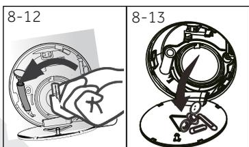
7. Dévissez et retirez le filtre de la pompe en le tournant dans le sens horaire (Fig. 8-12).
