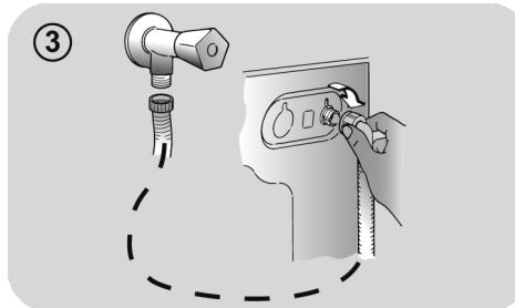
● **AQUASTOP** (**rys. 5**): urządzenie znajdujące się na przewodzie doprowadzającym wodę i blokujące dopływ wody w sytuacji, gdy przewód jest uszkodzony; w takim wypadku pojawi się czerwone oznaczenie w okienku "A", niezbędną będzie wymiana przewodu. Aby odkręcić tulejkę nacisnąć przycisk blokujący odkuczenie "B".
