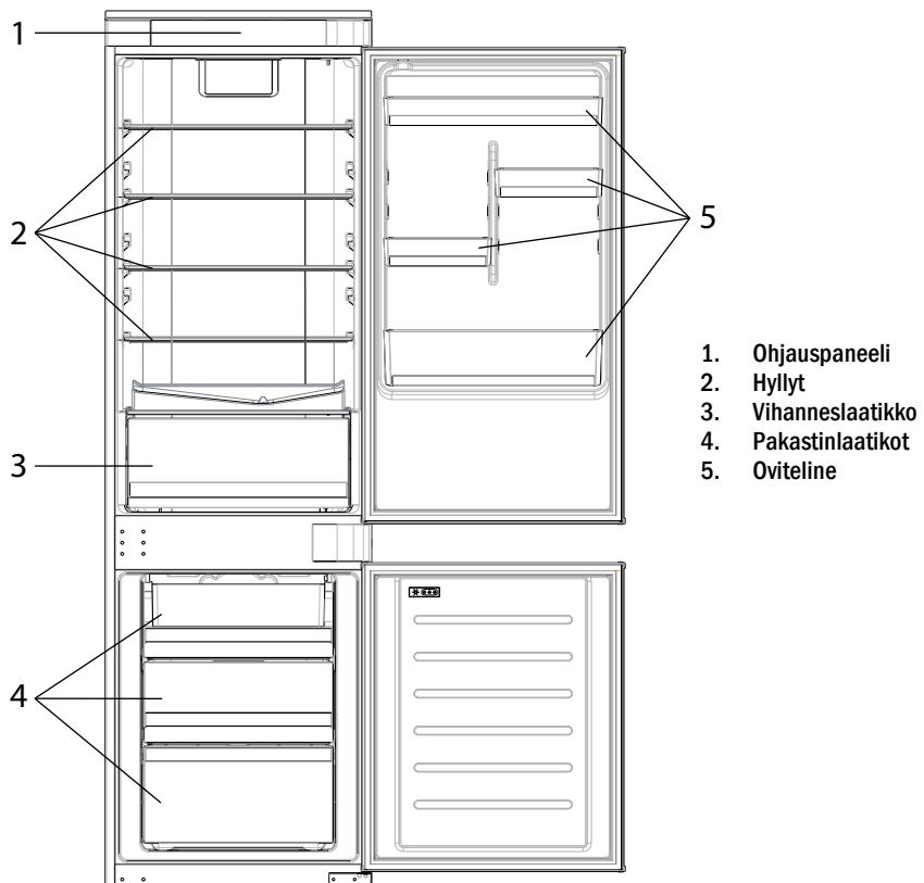
\* Laite käyttää vähiten energiaa, kun hylyt, laatikot ja ruokalaatikko on asetettu laitteen sisään ja tuuletin on pois päältä. Katso lisätietoja yläpuolella olevista kuvista.
