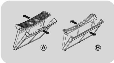
3. Retirez délicatement les peluches des deux filtres avec l'extrémité de vos doigts, une brosse souple ou un chiffon.
