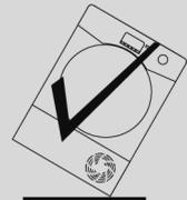
Si le produit est transporté différemment, attendez au moins 4 heures avant d'allumer l'appareil, ceci afin que le gaz liquide retourne dans le compresseur. En cas de non respect de cette procédure, le compresseur pourrait être endommagé.
