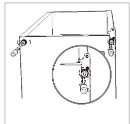
**Voorzichtig!** Als er een schroef links in de hoek aan de voorkant zit, verwijder die dan voordat u het scharnier installeert.
