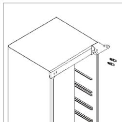
3. Retire a tampa e os parafusos do lado esquerdo e coloque-os no lado direito.
