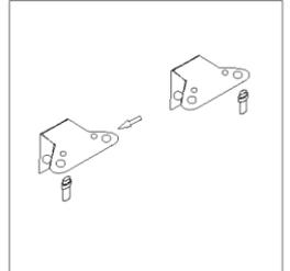
8. Mettez l'appareil à la verticale et placez la porte sur la charnière inférieure. Assurez-vous que la partie centrale de la charnière inférieure est insérée dans le trou de la porte. Montez ensuite la charnière supérieure sur la porte. Avant de fixer solidement la charnière supérieure, essayez d'ouvrir la porte pour vérifier si l'appareil ferme bien hermétiquement. Enfin, vissez le cache de la charnière avec la charnière.
