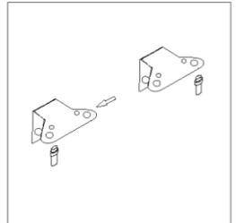
8. Postavte jednotku a nasadte dvere na spodný záves. Uistite sa, že jadro spodného závěsu je vložené do otvoru dverí. Potom pripevnite horný záves k dverám. Pred dokončením upevnenia horného závěsu skúste otvoriť dvere, aby ste skontrolovali, či dobre doliehajú na skriňu. Nakoniec naskrutkujte kryt závěsu so závesom.
