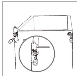
7. Deșurubați știftul balamalei superioare și montați-l în orificiul din stânga.
