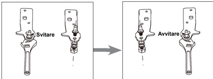
6. Installare la cerniera sul lato sinistro e la base del piedino sul lato destro. Quindi avvitare due piedini di livellamento con le loro parti originali.
