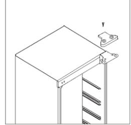
2. Otevřete dvířka a odšroubujte horní závěs. Potom odstraňte dvířka ze skříně a položte je na měkkou podložku, aby nedošlo k poškození.
