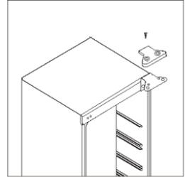
2. Open de deur en schroef het bovenste scharnier los. Verwijder vervolgens de deur van de kast en leg hem op een zachte onderlegger om beschadiging te voorkomen.
