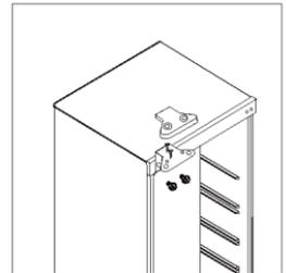
9. Lösen Sie die Türdichtungen des Kühl- und Gefrierschranks, drehen Sie sie und bringen Sie sie wieder an.
