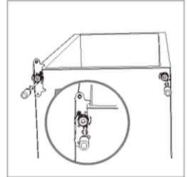
7. Schrauben Sie den oberen Scharnierstift ab und setzen Sie ihn in das linke Loch ein.
