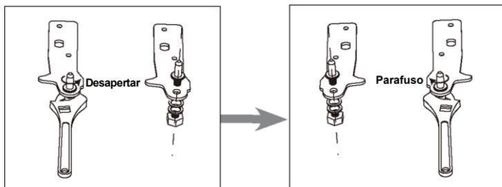
6. Instale a dobradiça do lado esquerdo e a base do pé do lado direito. Em seguida, aparafuse dois pés niveladores com as respectivas peças originais.
