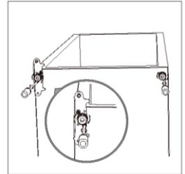
7. Schroef de bovenste scharnierpen los en monteer hem in het linkergat.
