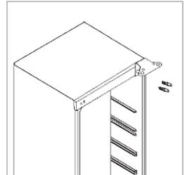
3. Scoateți capacul și șuruburile din partea stângă și montați-le pe partea dreaptă.
