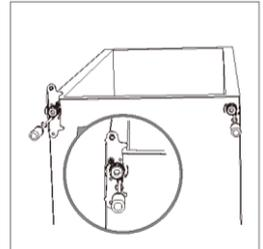
7. Odšroubujte čep horního závěsu a namontujte ho do levého otvoru.
