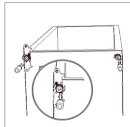
7. Svitare il perno della cerniera superiore e montarlo sul foro sinistro.
