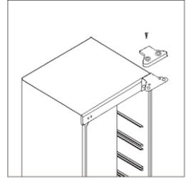
2. Deschideți ușa și deșurubați balamaua superioară. Apoi scoateți ușa din dulap și puneți-o pe un suport moale pentru a evita deteriorarea.
