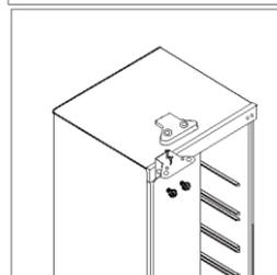
9. Retire as juntas da porta do Frigorífico e do Congelador e, em seguida, fixe-as após rodar.
