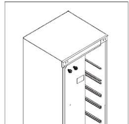
4. Legen Sie die Rückseite des Gehäuses vorsichtig auf eine weiche Unterlage. Entfernen Sie zunächst zwei Stellfüße. Schrauben Sie dann das Türscharnier und den linken Fußsockel ab.
