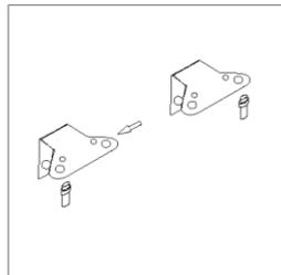
8. Alzare l'unità in verticale e posizionare la porta sulla cerniera inferiore. Assicurarsi che il perno della cerniera inferiore sia inserito nel foro della porta. Quindi montare la cerniera superiore sulla porta. Prima di fissare saldamente la cerniera superiore, provare ad aprire la porta per verificare che il frigorifero sia ben sigillato. Avvitare infine il coperchio della cerniera alla cerniera.
