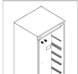
4. Așezați cu grijă partea din spate a dulapului pe un suport moale. Îndepărtați mai întâi cele două piciorușe de uniformizare. Apoi deșurubați balamaua ușii și baza piciorului stâng.
