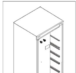
4. Leg de achterkant van de kast voorzichtig op een zachte ondergrond. Verwijder eerst de twee stelvoeten. Schroef vervolgens het deurscharnier en de linkervoet los.
