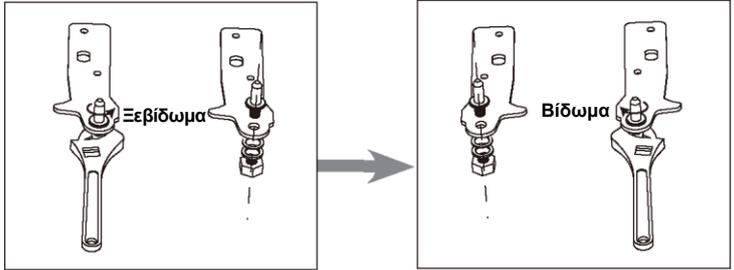
6. Τοποθετήστε τον μεντεσέ στην αριστερή πλευρά και τη βάση ποδιού στη δεξιά πλευρά. Στη συνέχεια βιδώστε δύο πόδια οριζοντίως με τα αρχικά τους εξαρτήματα.
