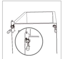
7. Odskrutkujte čap horného závěsu a namontujte ho do ľavého otvoru.
