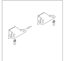
8. Postavte spotřebič a nasadte dvířka na dolní závěs. Ujistěte se, že jádro dolního závěsu je vloženo v otvoru ve dvířkách. Potom nasadte dvířka na horní závěs. Než pevně připevníte horní závěs, zkuste otevřít dvířka, abyste zkontrolovali, zda je skříň správně utěsněná. Nakonec přišroubujte kryt závěsu na závěs.
