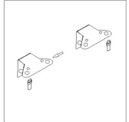
8. Postaw urządzenie i załóż drzwi na dolny zawias. Sprawdź, czy rdzeń dolnego zawiasu jest wsunięty w otwór drzwi. Następnie zamontuj górny zawias do drzwi. Przed dokładnym zamocowaniem górnego zawiasu spróbuj otworzyć drzwi szafki i sprawdź, czy jest ona dobrze uszczelniona. Na koniec przykręć osłonę zawiasu do zawiasu.
