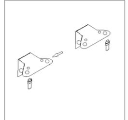
8. Σηκώστε τη μονάδα όρθια και τοποθετήστε την πόρτα στον κάτω μεντεσέ. Βεβαιωθείτε ότι ο πείρος του κάτω μεντεσέ έχει εισαχθεί στην οπή της πόρτας. Στη συνέχεια τοποθετήστε τον επάνω μεντεσέ με την πόρτα. Πριν στερεώσετε καλά τον επάνω μεντεσέ, δοκιμάστε να ανοίξετε την πόρτα για να ελέγξετε αν το έπιπλο είναι καλά προσκολλημένη. Τέλος, βιδώστε το κάλυμμα μεντεσέ με τον μεντεσέ.
