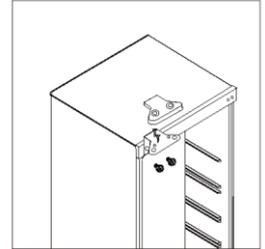
9. Maak de pakkingen van de koelkast- en vriezerdeur los en plaats ze na het draaien van de deur terug.
