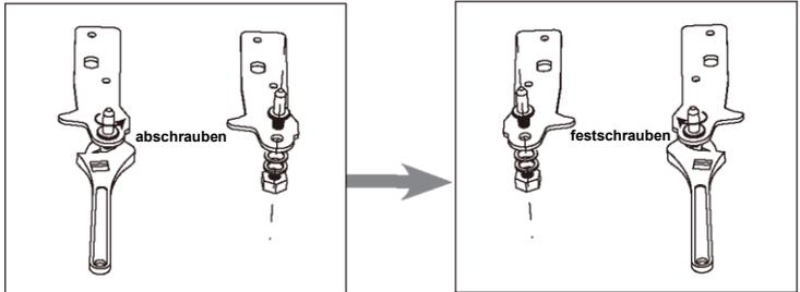
6. Montieren Sie das Scharnier an der linken Seite und den Fuß an der rechten Seite. Schrauben Sie dann zwei Nivellierfüße mit ihren Originalteilen an.
