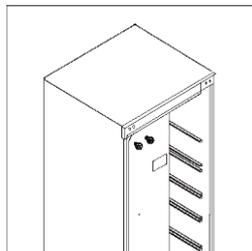
4. Deite cuidadosamente a parte de trás do armário sobre uma superfície macia. Retire primeiro os dois pés de nivelamento. Em seguida, desaperte a dobradiça da porta e a base do pé esquerdo.
