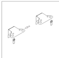
8. Levante a unidade e coloque a porta na dobradiça inferior. Certifique-se de que o núcleo da dobradiça inferior está inserido no orifício da porta. Em seguida, encaixe a dobradiça superior na porta. Antes de fixar firmemente a dobradiça superior, tente abrir a porta para verificar se o armário está bem vedado. Por fim, aparafuse a tampa da dobradiça com a dobradiça.
