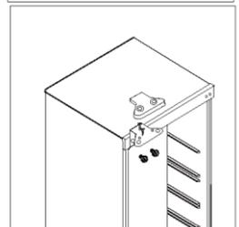
9. Szerelje le a hűtőszekrényt és a fagyasztóajtó tömítéseit, majd átfordítás után szerelje őket vissza.
