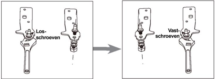
6. Installeer het scharnier aan de linkerkant en de voetbasis aan de rechterkant. Schroef vervolgens de twee stelvoeten vast met hun originele onderdelen.
