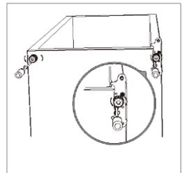
**Vorsicht!** Wenn sich an der linken vorderen Ecke eine Schraube befindet, entfernen Sie diese, bevor Sie das Scharnier einbauen.
