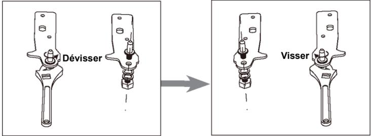
6. Installez la charnière sur le côté gauche et la base du pied sur le côté droit. Vissez ensuite deux pieds de réglage avec leurs pièces d'origine.
