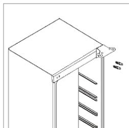
3. Retire la tapa y los tornillos del lado izquierdo y colóquelos en el lado derecho.
