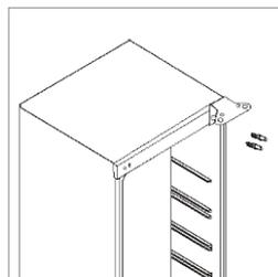
3. Retirez le cache et les vis du côté gauche et placez-les sur le côté droit.
