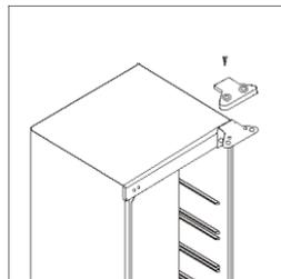
2. Abra la puerta y desatornille la bisagra superior. A continuación, saque la puerta y colóquela sobre una superficie blanda para evitar que se dañe.
