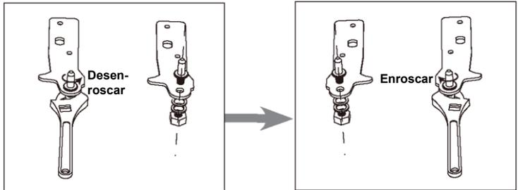
6. Instale la bisagra en el lado izquierdo y la base de la pata en el lado derecho. A continuación, atornille dos patas de nivelación con sus piezas originales.
