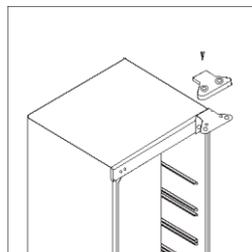
2. Abra a porta e desaperte a dobradiça superior. Em seguida, retire a porta do armário e coloque-a sobre uma superfície macia para evitar danos.
