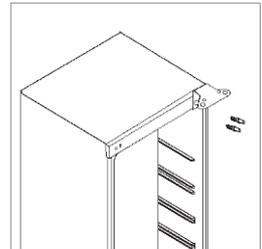
3. Αφαιρέστε το κάλυμμα και τις βίδες στην αριστερή πλευρά και τοποθετήστε τα στη δεξιά πλευρά.
