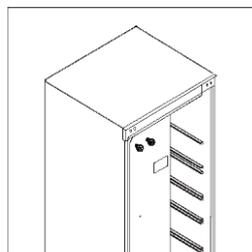
4. Allongez soigneusement l'arrière de l'appareil sur un support souple. Retirez d'abord les deux pieds de mise à niveau. Puis dévissez la charnière de la porte et la base du pied gauche.
