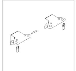
8. Levante la unidad y coloque la puerta en la bisagra inferior. Asegúrese de que el núcleo de la bisagra inferior está insertado en el orificio de la puerta. A continuación, encaje la bisagra superior con la puerta. Antes de fijar firmemente la bisagra superior, intente abrir la puerta para comprobar si el mueble está bien sellado. Por último, atornille la tapa de la bisagra con la bisagra.
