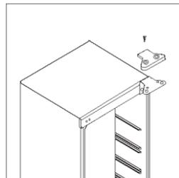
2. Ouvrez la porte et dévissez la charnière supérieure. Retirez ensuite la porte de l'appareil et placez-la sur un support souple pour éviter de l'endommager.
