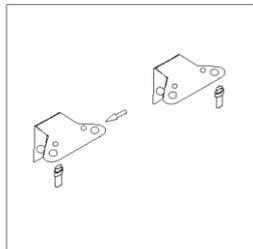
8. Ridicați unitatea și puneți ușa pe balamaua inferioară. Asigurați-vă că nucleul balamalei inferioare este introdus în orificiul ușii. Apoi se montează balamaua superioară cu ușa. Înainte de a fixa bine balamaua superioară, încercați să deschideți ușa pentru a verifica dacă dulapul este bine etanșat. În cele din urmă, înșurubați capacul balamalei cu balamaua.
