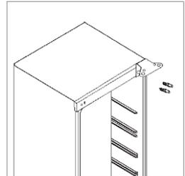
3. Entfernen Sie die Abdeckung und die Schrauben auf der linken Seite und bringen Sie sie auf der rechten Seite an.
