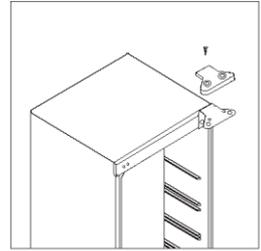
2. Öffnen Sie die Tür und schrauben Sie das obere Scharnier ab. Nehmen Sie dann die Tür aus dem Schrank und legen Sie sie auf eine weiche Unterlage, um Beschädigungen zu vermeiden.
