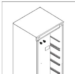
4. Apoye con cuidado la parte trasera del mueble sobre una superficie blanda. Retire primero las dos patas de nivelación. A continuación, desatornille la bisagra de la puerta y la base de la pata izquierda.
