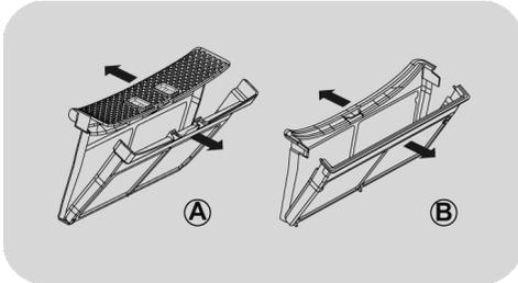
3. Flusen vorsichtig mit den Fingerspitzen, einer weichen Bürste oder einem Tuch von beiden Filtern entfernen.
