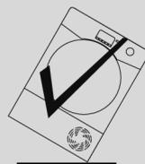
Wenn das Gerät in eine andere Lage transportiert wurde, warten Sie mindestens 4 Stunden, bevor Sie es einschalten, damit sich die Flüssigkeit im Kompressor wieder stabilisieren kann. Tun Sie es nicht, können Schäden am Kompressor die Folge sein.
