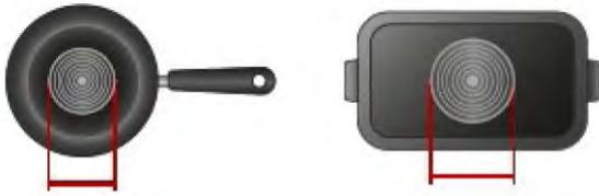
5. Se la parte ferromagnetica copre solo parzialmente la base della pentola, si riscalda solo l'area ferromagnetica e il resto della base potrebbe non raggiungere la temperatura sufficiente per la cottura.
