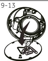
9. Reinigen Sie den Pumpenfilter vorsichtig und sorgfältig, am besten unter fließendem Wasser (Abb. 9-14).
