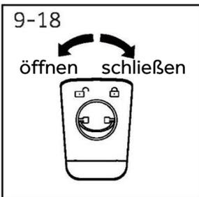
Um das Modul mit gereinigtem Wasser zu füllen, heben Sie den Ring an, drehen Sie ihn gegen den Uhrzeigersinn und ziehen Sie ihn heraus. Nach dem Befüllen mit gereinigtem Wasser schließen Sie den Deckel durch Drehen des Rings im Uhrzeigersinn, setzen Sie das Modul wieder in die Maschine ein und wählen Sie die i-Refresh Pro-Funktion, um ein spezielles Programm zu starten, der Ihre Kleidung auffrischt.
