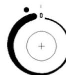
Méthode B : sélectionnez le commutateur de codage de la zone de cuisson correspondante et tournez le commutateur de codage dans le sens inverse des aiguilles d'une montre pour régler la plage de puissance de "0" à "15" et les anneaux intérieur et extérieur sont chauffés simultanément. Le point noir indiqué sur la figure montre que l'anneau extérieur est chauffé à ce moment-là.
