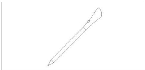
Mesure la température interne des aliments pendant la cuisson. Introduisez-la dans le trou sur le dessus de la cavité. Il convient de l'insérer pendant que le four est froid.
