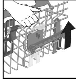
Zum Absenken: Halten Sie den Korb an den Seiten, drücken Sie die beiden B-Hebel an den Seiten des Korbs und senken Sie ihn ab.
