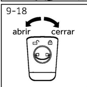
Para llenar el módulo con agua purificada, levante el anillo, gírelo en sentido antihorario y tire de él hacia fuera. Una vez lleno de agua purificada, cierre la tapa girando el anillo en el sentido de las agujas del reloj, vuelva a instalar el módulo en la máquina y seleccione la función i-Refresh Pro para iniciar un ciclo específico que refrescará su ropa.
