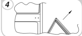
Retirer la charnière inférieure droite et les bouchons plastiques de gauche et les remettre en place sur le côté opposé.
