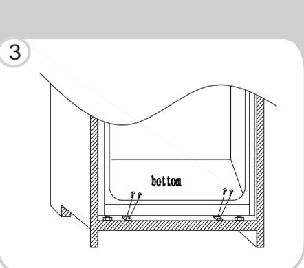
Ajuster le joint d'étanchéité de l'appareil, si nécessaire, découper la surlongueur. Fixer les pièces inférieures avec les caches plastiques.
