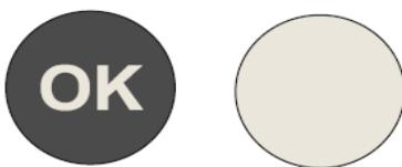
Se 'OK' não for exibido, a temperatura nessa parte está demasiado alta. Ajuste o termostato para uma posição superior. Aguarde pelo menos 12 horas antes de voltar a regular o termostato. Após a colocação de alimentos frescos no interior do aparelho ou após abertura repetida (ou prolongada) da porta, é normal que a indicação 'OK' não seja exibida no indicador de temperatura.
