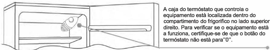
A caixa do termostato que controla o equipamento está localizada dentro do compartimento do frigorífico no lado superior direito. Para verificar se o equipamento está a funcionar, certifique-se de que o botão do termostato não está para "0".
