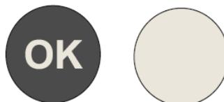
Εάν δεν εμφανίζεται το 'OK', η θερμοκρασία σε αυτό το τμήμα είναι πολύ υψηλή. Ρυθμίστε τον θερμοστάτη σε υψηλότερη θέση. Περιμένετε τουλάχιστον 12 ώρες πριν ρυθμίσετε ξανά τον θερμοστάτη. Αφού τοποθετήσετε φρέσκα τρόφιμα μέσα στη συσκευή ή μετά από επαναλαμβανόμενο (ή παρατεταμένο) άνοιγμα της πόρτας, είναι φυσιολογικό να μην εμφανίζεται η ένδειξη 'OK' στην ένδειξη θερμοκρασίας.
