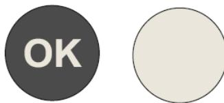
Si no aparece 'OK', la temperatura en esa parte es demasiado alta. Ajuste el termostato a una posición más alta. Espere al menos 12 horas antes de volver a ajustar el termostato. Despues de colocar alimentos frescos dentro del aparato o despues de la apertura repetida (o prolongada) de la puerta, es normal que la indicación 'OK' no se muestre en el indicador de temperatura.
