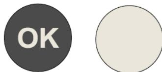
Se "OK" non viene visualizzato, significa che la temperatura in quella parte è troppo elevata. Impostare il termostato su una posizione più alta. Attendere almeno 12 ore prima di regolare nuovamente il termostato. Dopo aver inserito alimenti freschi all'interno dell'elettrodomestico o dopo ripetute (o prolungate) aperture della porta, è normale che l'indicazione "OK" non venga visualizzata sull'indicatore.
