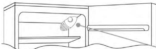
Gumb termostata za kontrolu temperature uređaja nalazi se u unutarnjem prostoru hladnjaka s gornje desne strane. Da provjerite da li uređaj funkcionira, budite sigurni da gumb termostata nije postavljen na položaj "0".
