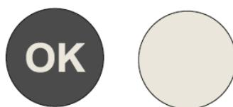
Wenn nicht „OK“ angezeigt wird, ist die Temperatur in diesem Bereich zu hoch. Stellen Sie das Thermostat auf eine höhere Stufe. Warten Sie mindestens 12 Stunden, bevor Sie das Thermostat neu einstellen. Nach dem Einlegen frischer Lebensmittel in das Gerät oder nach wiederholtem (oder längerem) Öffnen der Tür ist es normal, dass auf der Temperaturanzeige nicht „OK“ angezeigt wird.
