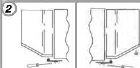
Fjern hettene (A) og (B), skru av skruene og trekk dekselet delvis av.
