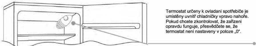
Termostat určeny k ovládání spotřebiče je umístěny uvnitř chladničky vpravo nahore. Pokud chcete zkontrolovat, že zařízení opravdu funguje, přesvědčete se, že termostat není nastavený v poloze „0“.
