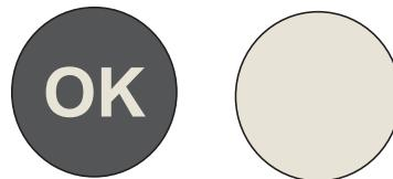
Om "OK" inte visas är zontemperaturen för hög. Ställ termostaten i ett högre läge. Vänta minst 12 timmar innan du återställer termostaten. Efter att ha fyllt på färsk mat i apparaten eller efter att ha öppnat luckan igen (eller under en längre tid) är det normalt att "OK"-indikatorn inte visas på temperaturdisplayen.
