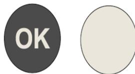
Ako se ne prikazuje „OK“ (U redu), temperatura je u tom dijelu previsoka. Postavite termostat na veću vrijednost. Pričekajte najmanje 12 sati prije ponovnog namještanja termostata. Nakon stavljanja svježe hrane u hladnjak ili nakon uzastopnog (ili duljeg) otvaranja vrata normalno je da se na pokazivaču temperature ne prikazuje „OK“ (U redu).
