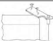
Invertire la direzione della cerniera e fissarla sulla parte superiore sinistra.
