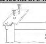
Rimuovere il tappo sulla parte sinistra e inserirlo sulla parte destra dell'antenna centrale.
