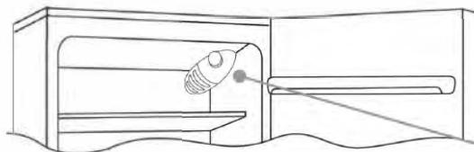
La caja del termostato para controlar el electrodoméstico está en el interior de la parte superior derecha. Para comprobar si está funcionando el electrodoméstico, asegúrese de que el regulador del termostato no esté en la posición 0.
