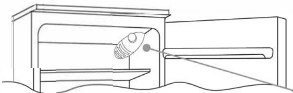
Laitteen säätöön tarkoitettu termostaattilaatikko sijaitsee jäätkaappiosaston sisällä oikealla ylhäällä. Kun haluat tarkastaa, että laite toimii, varmista, että termostaatinpippi ei ole asennossa "0".
