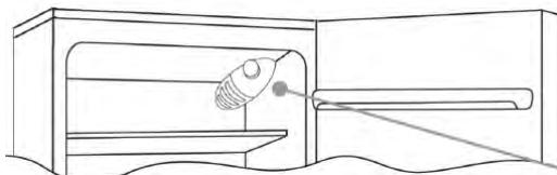
Termostat určeny k ovládani spotřebiče je umístěny uvnitř chladničky upravo nahore. Pokud chcete zkontrolovat, že zařízení opravdu funguje, přesvědčete se, že termostat není nastaven v poloze „0“.
