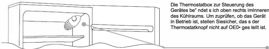
Die Thermostatbox zur Steuerung des Gerätes befindet sich oben rechts im Inneren des Kühlraums. Um zu prüfen, ob das Gerät in Betrieb ist, stellen Sie sicher, dass der Thermostatknopf nicht auf OE0° gesetzt ist.
