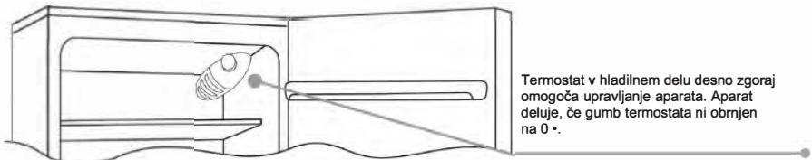
Termostat v hladilnem delu desno zgoraj omogoča upravljanje aparata. Aparat deluje, če gumb termostata ni obrnjen na 0 °.
