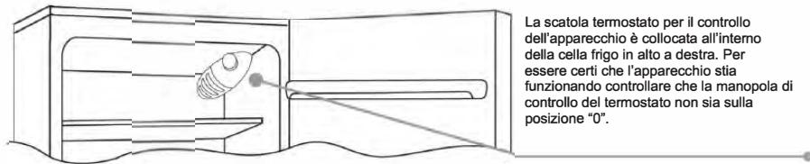
La scatola termostato per il controllo dell'apparecchio è collocata all'interno della cella frigo in alto a destra. Per essere certi che l'apparecchio stia funzionando controllare che la manopola di controllo del termostato non sia sulla posizione "0".
