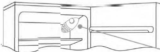
Le thermostat commandant l'appareil se trouve en haut à droite à l'intérieur du réfrigérateur. Pour vérifier que l'appareil fonctionne, assurez-vous que le bouton du thermostat ne se trouve pas en position "0".
