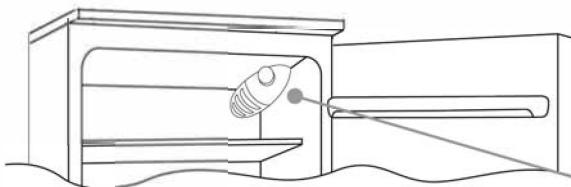
Den termostatboks, der styrer temperaturen i skabet, sidder indvendig i køleafdelingen foroven til højre. Når det kontrolleres, om skabet fungerer, skal det sikres, at termostatkappen ikke står på „0“.
