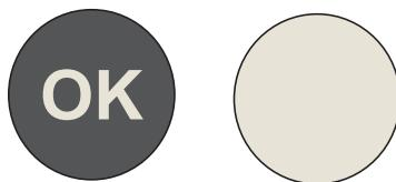
Ak sa „OK“ nezobrazí, teplota zóny je príliš vysoká. Nastavte termostat do vyšej polohy. Pred resetovaním termostatu počkajte aspoň 12 hodín. Po vložení čerstvých potravín do spotrebiča alebo po opäťovnom otvorení dvierok (alebo po dlhšom čase) je normálne, že sa na displeji teploty nezobrazí indikátor „OK“.
