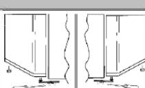
En la parte superior, extraer las protecciones de los tornillos y desenroscarlos.
