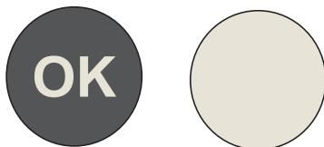
Če se "OK" ne prikaže, je temperatura cone previsoka. Nastavite termostat na višji položaj. Počakajte vsaj 12 ur, preden ponastavite termostat. Po nalaganju svežih živil v aparat ali po ponovnem odprtju vrat (ali daljšem času) je normalno, da se indikator "OK" ne prikaže na prikazovalniku temperature.
