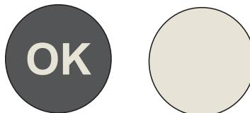
Hvis "OK" ikke vises, er zonetemperaturen for høj. Indstil termostaten til en højere position. Vent mindst 12 timer, før du nulstiller termostaten. Efter at have lagt frisk mad i apparatet eller efter at have åbnet døren igen (eller i længere tid), er det normalt, at "OK"-indikatoren ikke vises på temperaturdisplayet.
