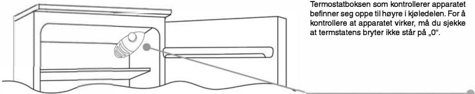
Termostatboksen som kontrollerer apparatet befinner seg opp til høyre i kjøledelen. For å kontrollere at apparatet virker, må du sjekke at termstatatens bryter ikke står på „0“.
