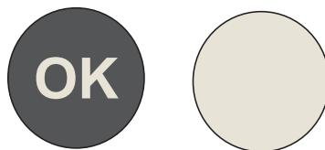
Hvis "OK" ikke vises, er sonetemperaturen for høy. Sett termostaten til en høyere posisjon. Vent minst 12 timer før du tilbakestiller termostaten. Etter å ha lagt inn ferske matvarer i apparatet eller etter å ha åpnet døren igjen (eller i lang tid), er det normalt at "OK"-indikatoren ikke vises på temperaturdisplayet.
