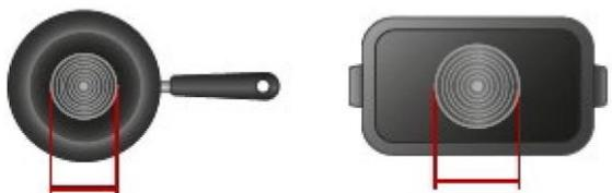
5. Si la partie ferromagnétique ne couvre que partiellement la base de la casserole, seule la zone ferromagnétique se réchauffera, le reste de la base pourrait ne pas chauffer à une température suffisante pour cuire.
