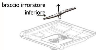
Per rimuovere il braccio irroratore inferiore, sollevarlo dalla base della lavastoviglie. Sciacquare accuratamente il braccio irroratore sotto l'acqua corrente, quindi rimontarlo. Assicurarsi che il braccio ruoti liberamente una volta rimontato.
