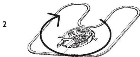
Riposizionare il filtro di scarico nella base della lavastoviglie. Ruotare 2 volte in senso orario per rimettere il filtro in posizione con un clic.
