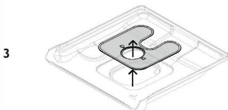
Rimuovere il filtro di scarico e la piastra del filtro. Utilizzare una spugna per rimuovere l'acqua che ristagna sotto prima di riposizionare la piastra.
