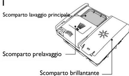
Verificare che il dosatore sia vuoto e asciutto. Aggiungere detersivo in polvere o pastiglie nel dosatore detersivo.
