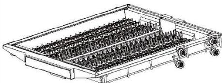
Utilisez le plateau pour les couverts et les ustensiles. Placer les couverts dans l'encoche pour les bloquer. Placez les grands ustensiles dans la partie centrale du plateau. Faites glisser les sections latérales vers le milieu pour créer plus d'espace pour l'article en-dessous.
