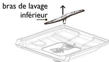
Pour retirer le bras de lavage inférieur, soulevez-le de la base du lave-vaisselle. Rincez abondamment le bras de lavage sous l'eau courante, puis remettez-le en place. Vérifiez que le bras tourne librement lorsqu'il est réinstallé.
