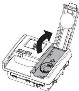
Si le voyant du liquide de rinçage s'allume, remplissez le distributeur de liquide de rinçage.
