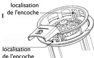
Alignez le bouchon du filtre sur l'encoche sur la base du filtre. Vérifiez que la structure de la boucle est en place.
