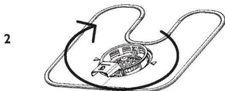
Remettez le filtre de vidange dans le fond du lave-vaisselle. Tournez 2 fois dans le sens des aiguilles d'une montre pour le mettre en place.
