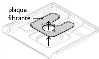
Lorsque le filtre est retiré, soulevez soigneusement la plaque filtrante vers le haut et vers l'extérieur. Nettoyez à l'eau chaude et rincez abondamment.
