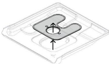
Retirez le filtre de vidange et la plaque filtrante. Utilisez une éponge pour retirer le reste d'eau en dessous avant de les remettre en place.
