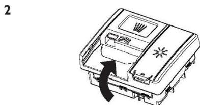
Retirez tout excès de détergent puis faites glisser le couvercle pour le fermer. Il émettra un clic. Si nécessaire, ajoutez du détergent supplémentaire dans le compartiment de pré-lavage sur le dessus du distributeur.
