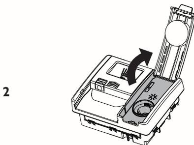
Soulevez le couvercle et versez du liquide de rinçage dans l'ouverture. N'allez pas au-delà de la ligne MAX. Veillez à ne pas renverser du liquide sur la porte ou le réservoir de détergent.
