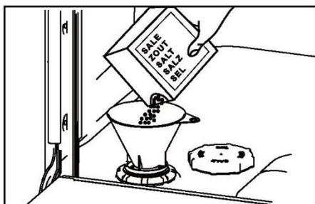
1. Tournez le bouchon dans le sens des aiguilles d'une montre pour ouvrir le réservoir de sel.
