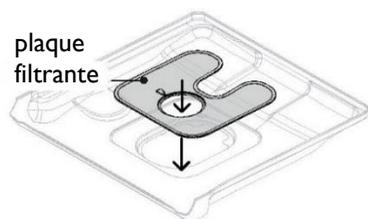
Insérez la plaque filtrante dans les clips de repérage à l'arrière de la vidange et poussez pour enclencher. Vérifiez que la plaque filtrante affleure au fond du lave-vaisselle.
