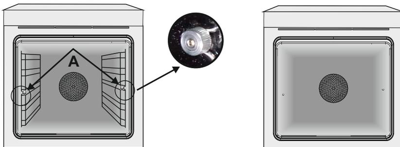
en place, remontez les boulons et serrez-les à fond.
