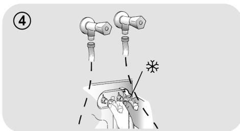
Connectez le tuyau gris au robinet d'eau froide ❄ et le rouge au robinet d'eau chaude. L'appareil peut être connecté au robinet d'eau froide: dans ce cas, certains programmes peuvent démarrer quelques minutes plus tard..
