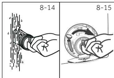
9. Pulire con attenzione il filtro della pompa, ad esempio servendosi di acqua di rubinetto (Fig. 8-14).
