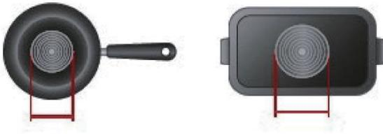
5. Si la partie ferromagnétique ne couvre que partiellement la base de la casserole, seule la zone ferromagnétique se réchauffera, le reste de la base pourrait ne pas chauffer à une température suffisante pour cuire.
