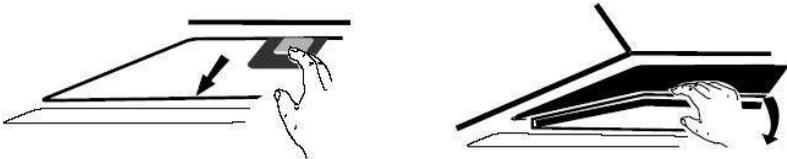
Setzen Sie den Aktivkohlefilter in das Gerät ein und drehen Sie ihn im Uhrzeigersinn. Wiederholen Sie diesen Vorgang auf der anderen Seite.
