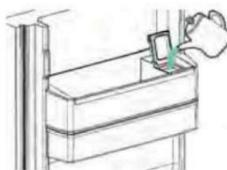
.2. املأ خزان المياه بالماء الصالح للشرب حتى خط 3 أي 3 لترات.
