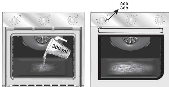
**N.B.:** In alcuni forni pirolitici con User Interface Precò Touch, è presente la funzione Aquactiva. Per attivarla impostare il selettori delle funzioni sul simbolo AQUACTIVA ( ) e impostare la temperatura del forno a 90°, utilizzando i tasti di regolazione “-” e “+”.
