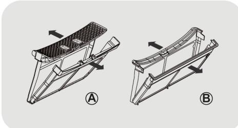
3. Nježno uklonite vlakna iz obaju filtrova služeći se vršcima prstiju ili mekom četkom, krpom ili pod tekućom vodom.
