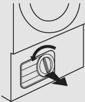
3. Reinig de warmtewisselaar voorzichtig met een zachte borstel of stofzuiger om stof of pluizen te verwijderen, en let er daarbij op dat de lamellen niet worden beschadigd.
