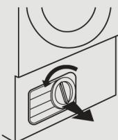
3. Toplotni izmenjevalnik nežno očistite z mehko krtačo ali sesalnikom, da odstranite prah ali kosme, pri tem pa pazite, da ne poškodujete rež.
