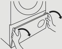
2. Draai de handgreep linksom en trek het voordeksel eruit.
