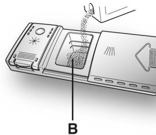
Po vložení mycího prostředku do zásobníku nejdříve uzavřete kryt, poté ho zasuňte (1) a nakonec na něj lehce zatlačte (2), až bude slyšet jeho zaskočení.
