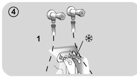
● **AQUAPROTECT - PRZEWÓD WODY Z ZABEZPIECZENIEM** (**rys. 6**): W przypadku wycieku wody z głównej rury wewnętrznej "A" jego przezroczysta osłona zewnętrzna "B" będzie wypełniona wodą, co pozwoli na ukończenie bieżącego prania. Po zakończeniu cyklu wymienić przewód kontaktując się z Centrum Serwisu Technicznego.
